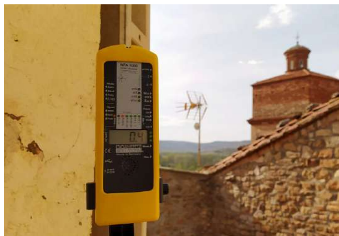
Foto 6. Medición de campo eléctrico alterno a pie de calle.
