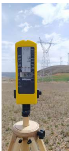
Foto 13. Medición de campo eléctrico alterno cerca de las torres.
