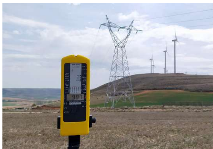
Foto 14. Medición de campo magnético alterno cerca de las torres.
