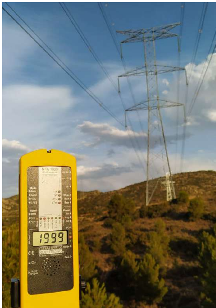
Foto 30. Terreno en Alcorisa. Valor de campo eléctrico alterno elevado.
