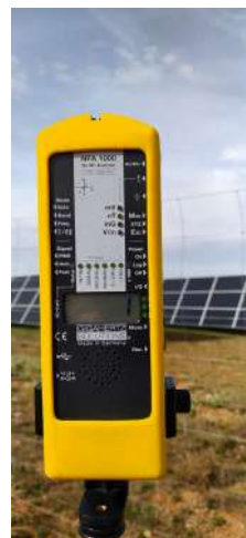
Foto 10. Medición de campo magnético alterno cerca de la valla.
