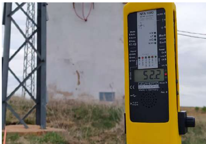
Foto 20. Medición de campo eléctrico alterno cerca de la torre.
