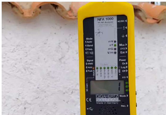
Foto 24. Medición de campo magnético alterno cerca de la línea.
