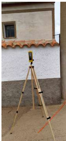
Foto 22. Medidor a 2 metros de línea de baja tensión.
