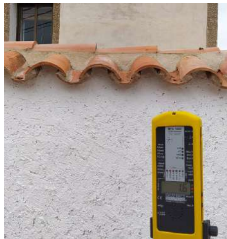
Foto 23. Medición de campo eléctrico alterno cerca de la línea.
